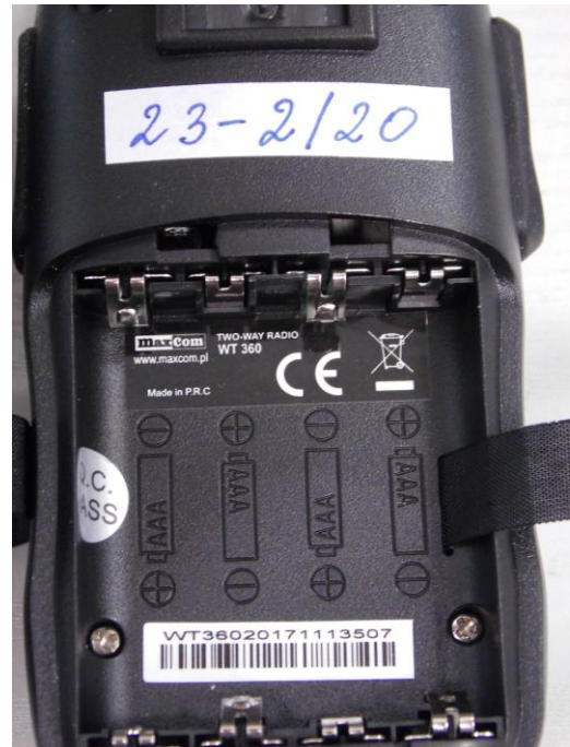
Widok radiotelefonów w środku – oznaczenie oraz numer seryjny
